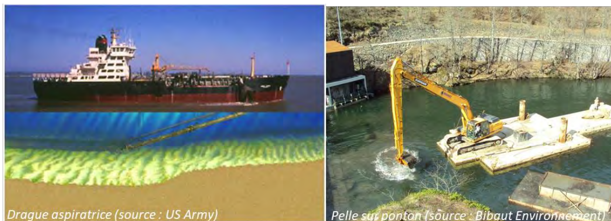
Figure 9 : Photos de dragage aspiratrice et pelle sur ponton
